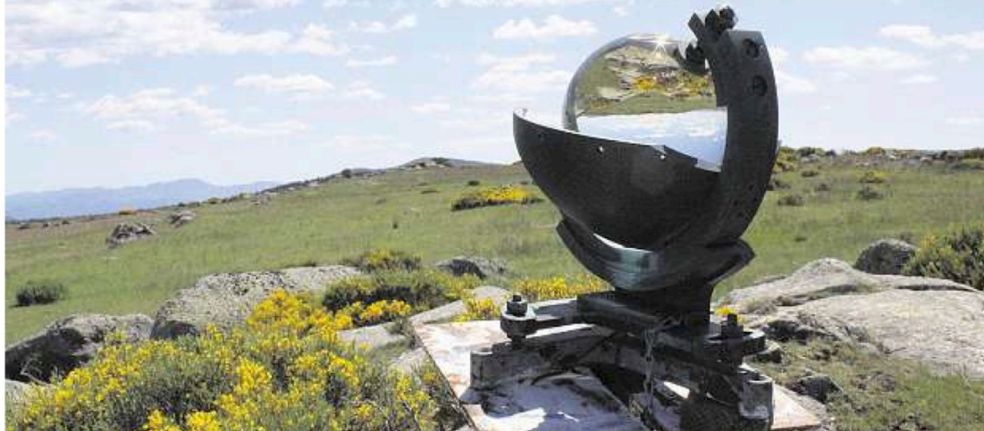
Autrefois utilisé pour mesurer les temps d'ensoleillement, cet héliographe a été l'un des derniers utilisés en France.
